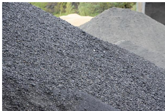
Figure 4. Agrégats d'enrobés du projet national MURE
